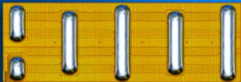
8 m $\Omega$ , 32 A, 162 A<sub>pulsed</sub>, 7.4 mm<sup>2</sup>
